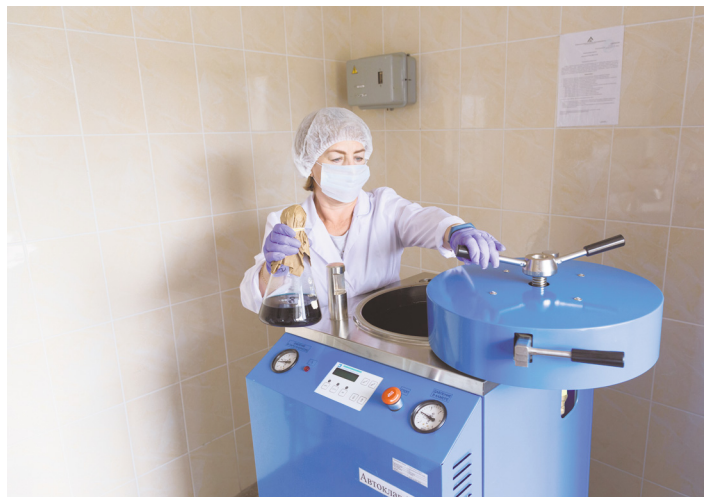
В автоклав, где происходит стерилизация, закладываются среды, которые затем используются в различных исследованиях.
